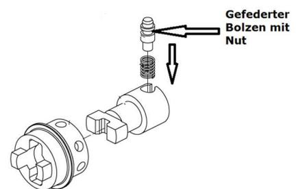
1. An der Rückseite des Zylinders mittels spitzem Gegenstand den gefederter Bolzen nach unten drücken
