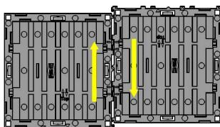
4. Doppeladapter auf die beiden Sprechgitter von hinten einrasten
