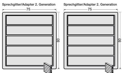
3. Adapter für Lautsprecher zusammenschieben, bis beide Elemente auf einer Ebene sind
