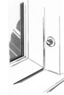
Den Bolzen nach rechts drehen, in die Wand schieben und leicht nach links drehen. Der Bolzen rastet in der Wand ein und ist nun arretiert.
