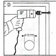
Zum Bohren benötigen Sie einen handelsüblichen **Ø 16 mm Bohrer**, der für eine **Bohrtiefe von 170 mm** ausreichend lang und für das anzubohrende Material geeignet ist (Stein, Holz, Beton).
