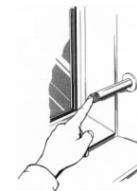
Einfach den Bolzen unter leichtem Druck nach rechts drehen. Der Bolzen fährt selbstständig aus der Wand und verriegelt. Der Bolzen sitzt fest.
