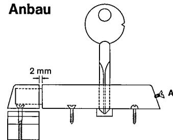
**1. Schließkasten montieren:**
