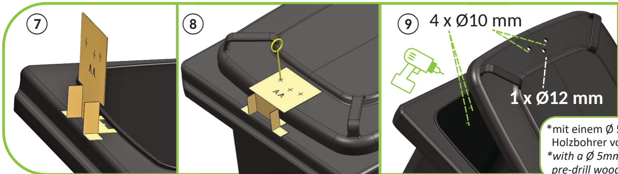
7 Schablone AA falten und an Markierung aufstellen Fold template AA and place at marking
