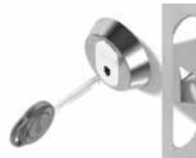
**3.1.2** Stecken Sie einen Nutzerschlüssel **einmal** in den Zylinder und drehen Sie ihn leicht.
