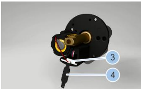
Abb. 92: Schraube und Batterie-stecker einsetzen
